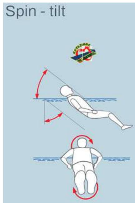
La camera di galleggiamento tridimensionale X3D system a singolo compartimento è realizzata in tessuto PA 420 OU COATED con saldature ad alta frequenza controllate elettronicamente. Il sistema garantisce una rapida ed immediata rotazione del corpo in acqua.
