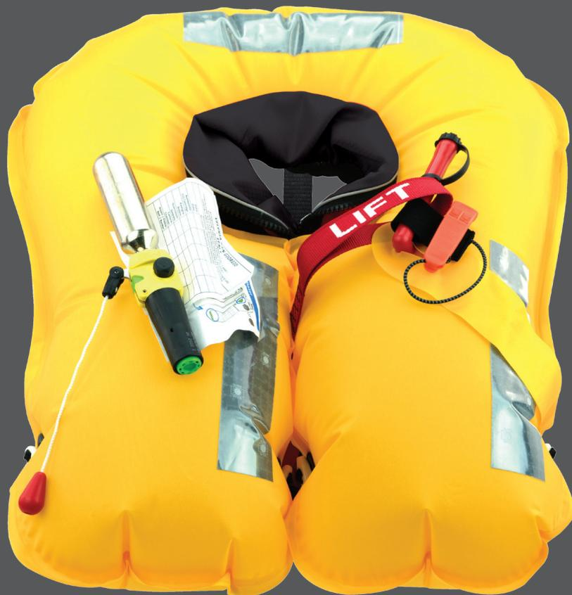
Camera di galleggiamento a singolo compartimento in tessuto PA 420 PU COATED con saldature ad alta frequenza controllate elettronicamente. Garantisce una posizione ottimale in acqua ed una perfetta stabilità. La spinta è tale da ruotare una persona priva di sensi e inclinarla consentendole di mantenere le vie respiratorie libere dall'acqua. Anche con camera gonfia è possibile nuotare agevolmente per raggiungere un posto sicuro o salire velocemente su una zattera.
